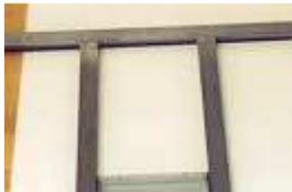
Auf ein ausgelegtes Trepierpapier (oder eine Backtrennfolie) werden Stäbe von etwa 12mm Dicke ausgelegt.
